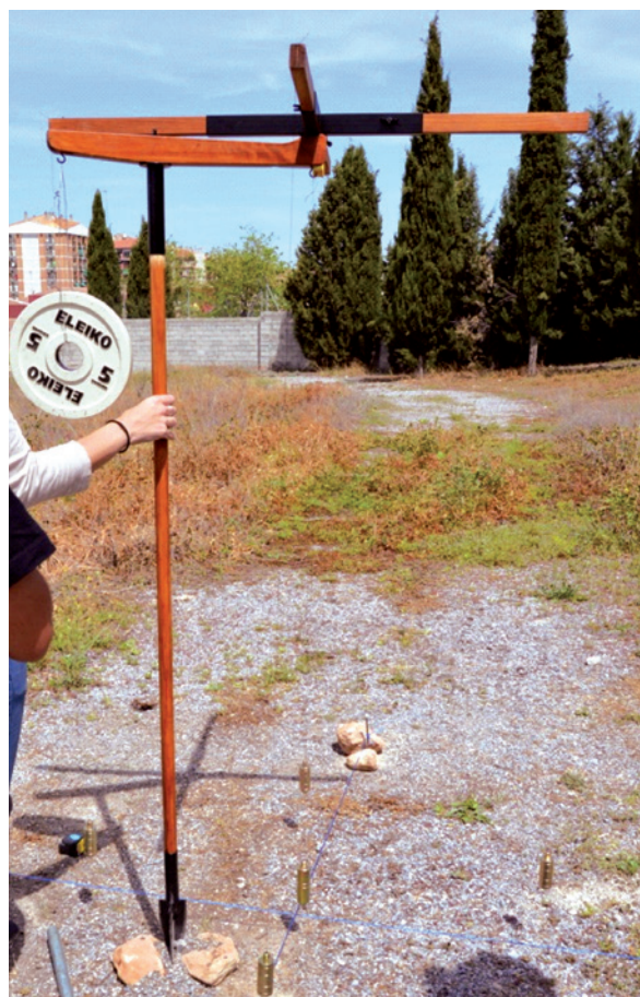
Figura 4. Prototipo de groma elaborada dentro del Proyecto SOTOER 2.
