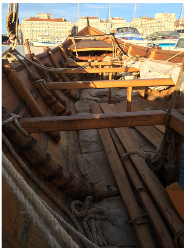
Figura 2. Vista del interior del casco de la réplica del Jules Verne 9, llamada Gyptis. Se puede observar la disposición de la carpintería transversal con la técnica de unión con el casco, armado este por cosidos.
