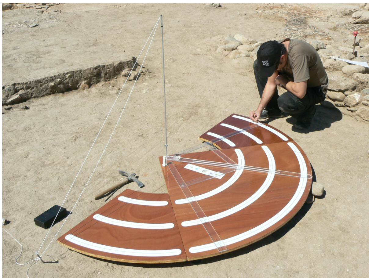
Figura 3. Prototipo de gnomon del Proyecto SOTOER, creado en el Parque de las Ciencias de Granada.
