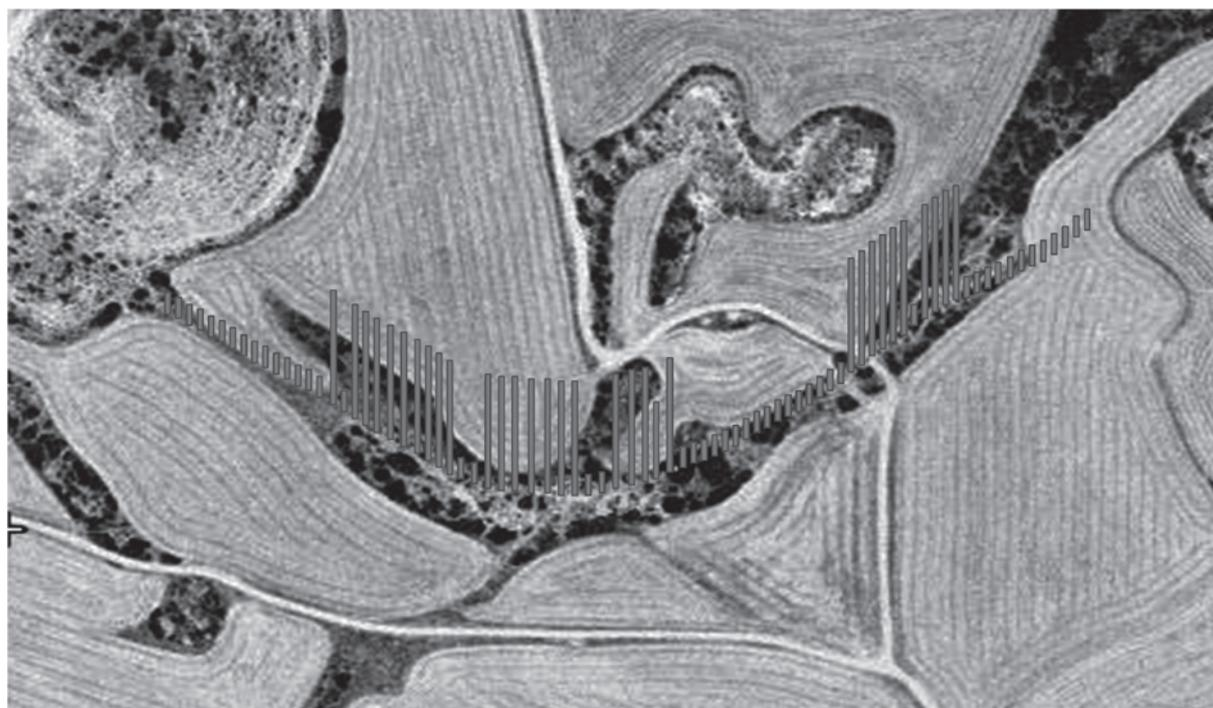
Figura 16. Representación del trazado de pilares del acueducto con distinción entre conservados (en claro), no conservados (en oscuro) e indicación correlativa de las diversas alturas conservadas (Dibujo: S. González Soutelo).
