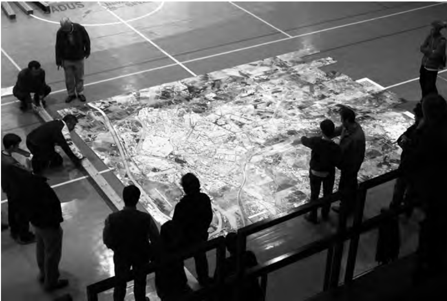
15. Maqueta de Sevilla y su entorno. Montaje en el pabellón Polideportivo de la ETSA de Sevilla. Maqueta de 5,70 x 4,50 metros realizada con teselas de 30 x 30 centímetros (soporte de capaline, base ortofotografía color, y edificación en láminas de pvc), noviembre, 2003.
