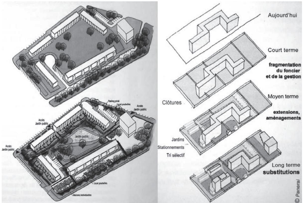
parcelas e individualizándolas por cajas de escaleras (coincidiendo comúnmente con las juntas de dilatación de los bloques), se ponen las bases para que los grandes edificios puedan transformarse o incluso sustituirse por partes (figura 7).
