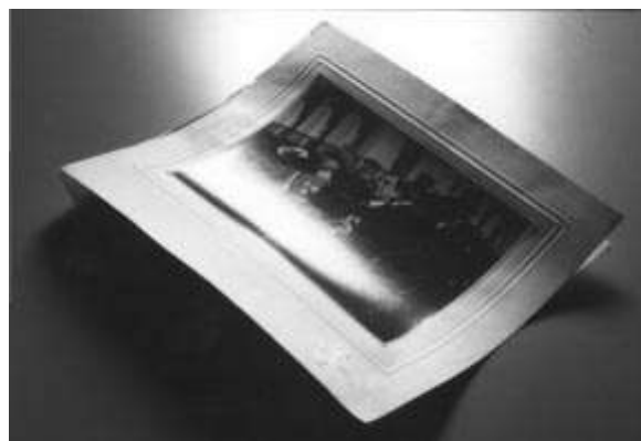
Figura 2 Abarquillamiento de los soportes por cambios de temperatura y humedad relativa. Fuente: I. Csillag.
