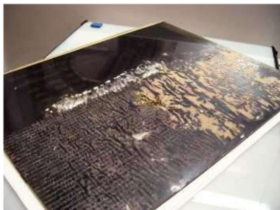
Figura 4 Negativo con restos de fibra de papel del envoltorio adherido a la emulsión de gelatina. Fuente: Archivo Ruiz Vernacci, IPCE. Tomado por A. Gutiérrez
