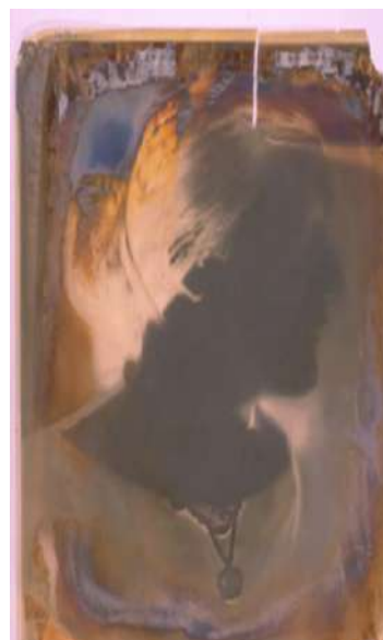
Figura 7 Negativo sobre base de nitrato de celulosa con avanzada hidrólisis ácida. Fuente: Á. Fuentes.
