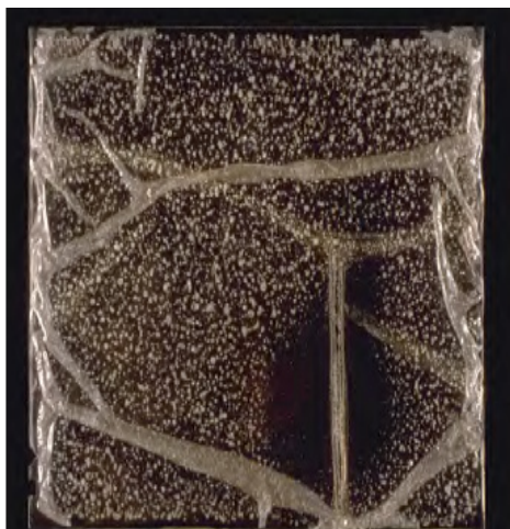
Figura 8 Negativo sobre base acetato de celulosa con hidrólisis ácida: encogimiento de la base, presencia de canales y exudación de plastificadores. Fuente: Á. Fuentes.
