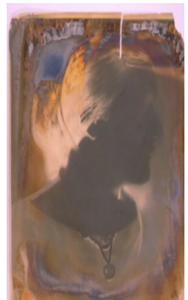
Figura 7 Negativo sobre base de nitrato de celulosa con avanzada hidrólisis ácida. Fuente: Á. Fuentes.
