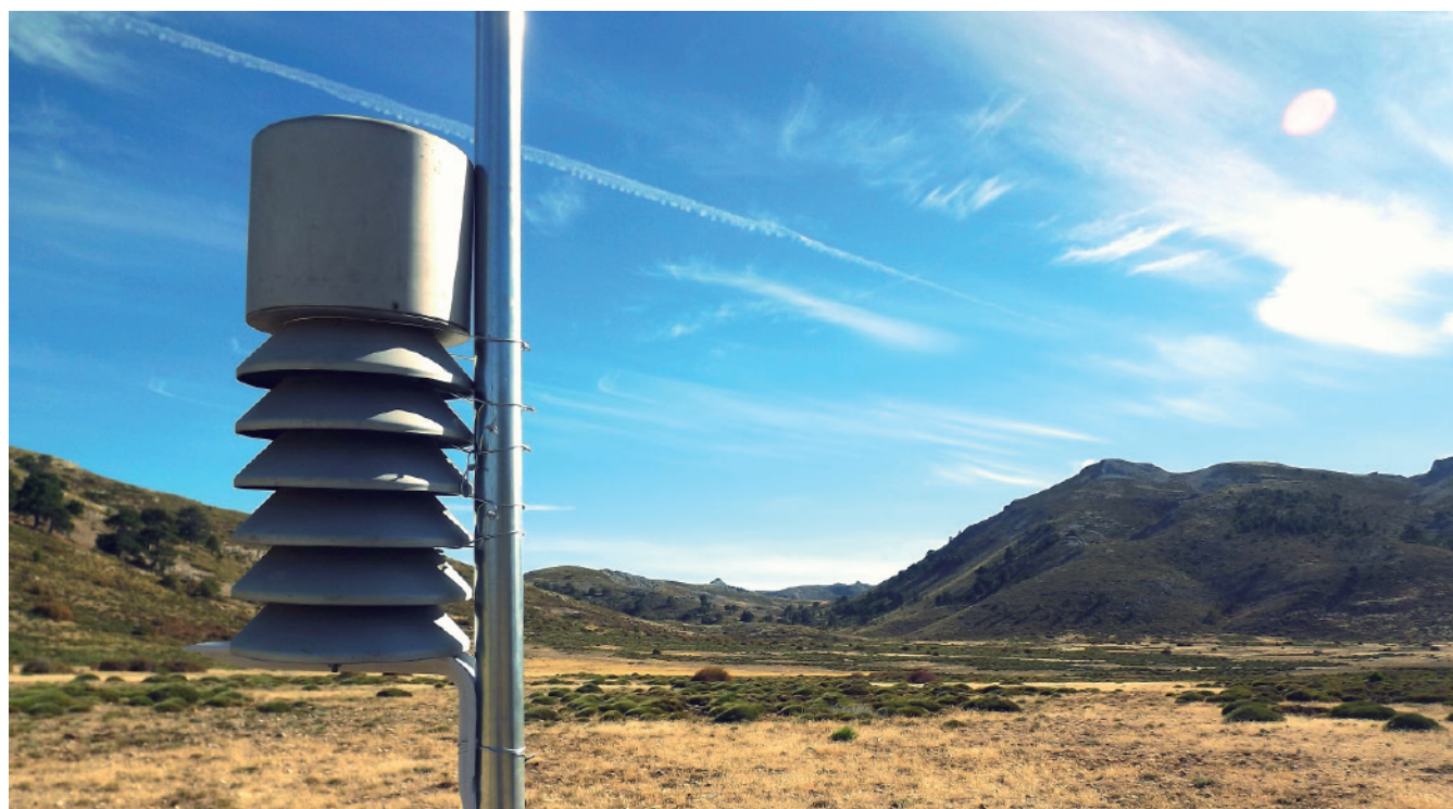
Imagen 1. Sensor térmico (datalogger) localizado en el polje colgado de Navalasnó (Jaén), a una altitud de 1770 m. Garita meteorológica de tipo Pagoda, cedida por AEMET Murcia, con sensor microlite 32K en su interior. Fuente: Autor.
