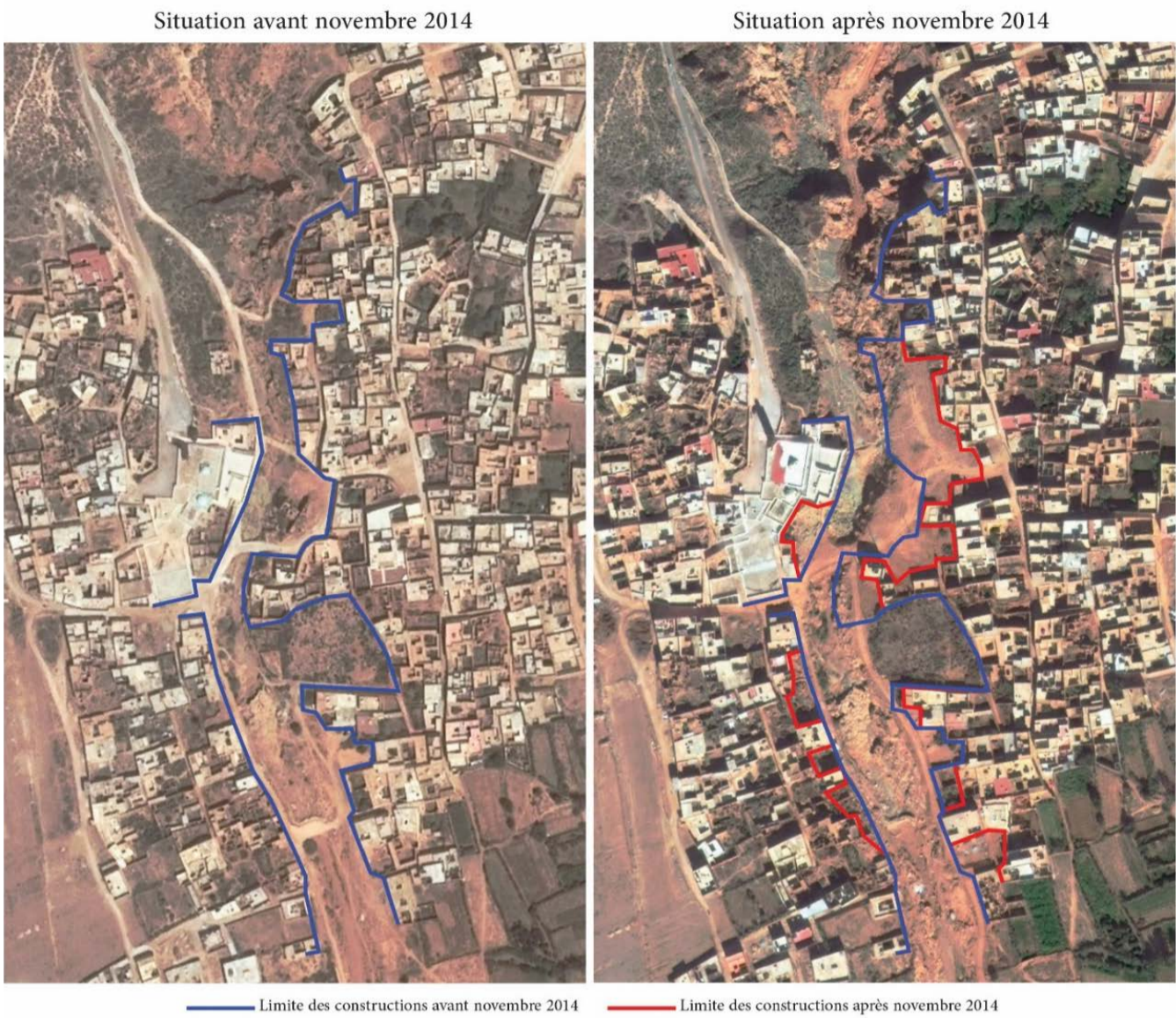
Figure 17. Dégâts causés par les inondations du novembre 2014 au niveau de Zaouiya Sidi Ouaggag. Source: propre élaboration basée sur l'analyse des images chronologique de Google Earth.
