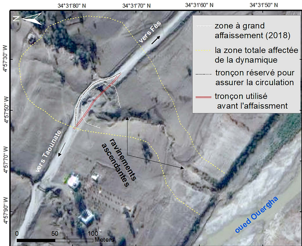
Figure 20 et photos 4-6. Quelques indices d'impact de la dynamique et instabilité du site. Source: image satellite et recherche de terrain –élaboration propre-.
