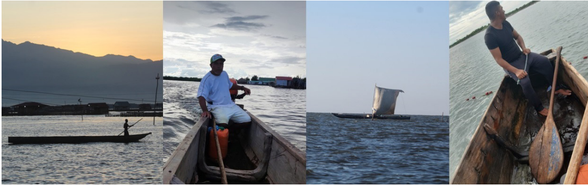
Imagen 4. Sistemas de propulsión empleados en la navegación de la Ciénaga Grande de Santa Marta. De izquierda a derecha: palanca, motor, vela y canalete. Fuente: Elaboración propia.
