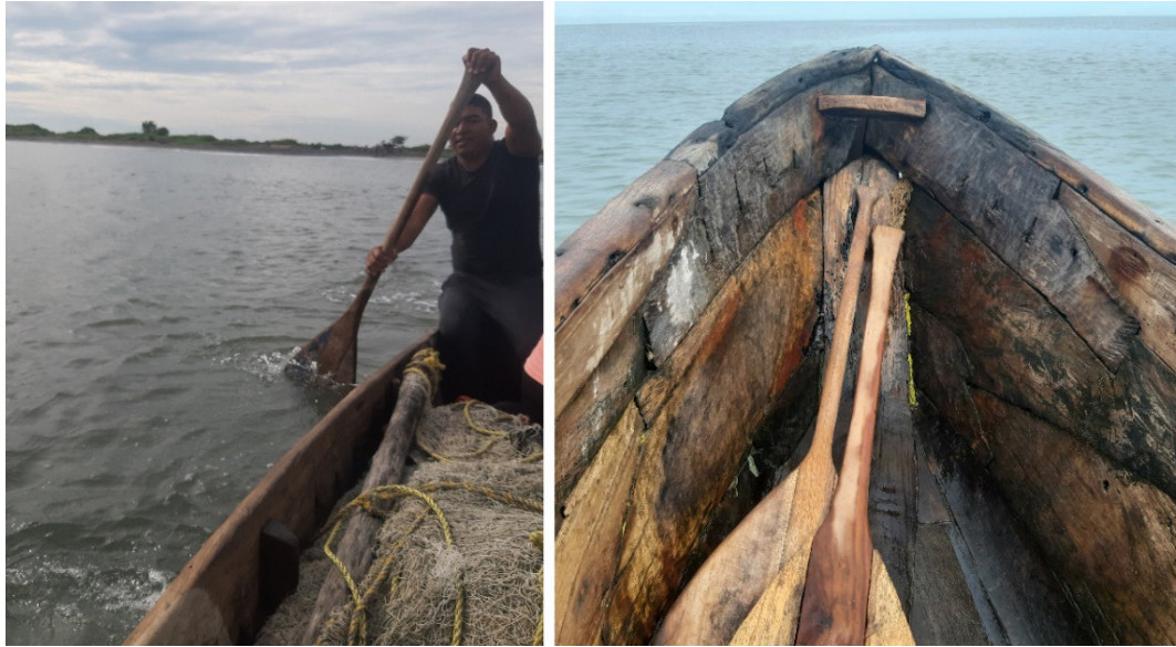
Imagen 8. Detalles de boga con canalete en mar (izq.) y canaletes de respeto en proa (drcha.) en el cayuco con el que se realizó la salida de mar en Tasajeras. Fuente: Elaboración propia.
