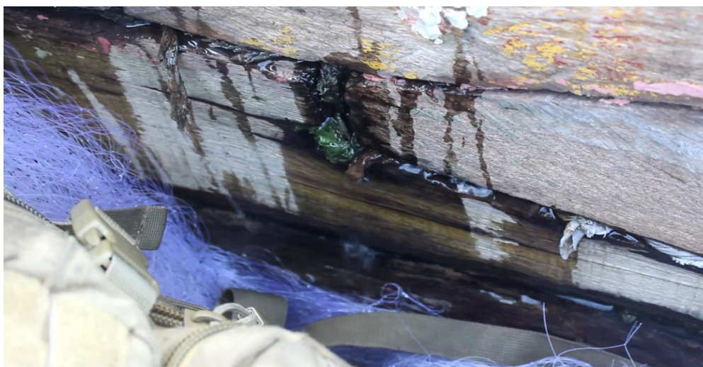
Imagen 6. Entrada de agua entre tracas durante navegación en la Ciénaga Grande. Fuente: Elaboración propia.
