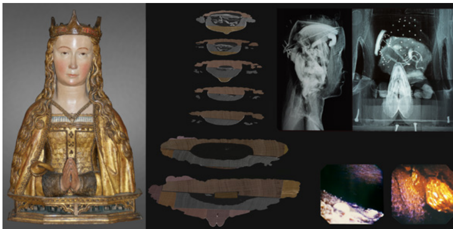
Figura 3. Imágenes del estudio tomográfico, radiográfico y endoscopia del busto relicario de Santa Balbina , Museo Diocesano de Arte Sacro de Vitoria.
