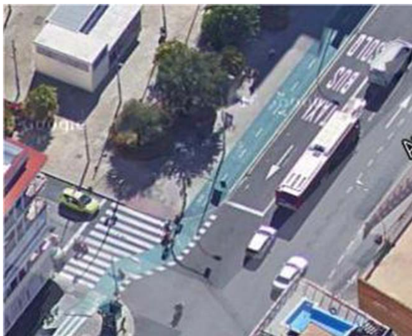
Figura 1. Carril-bici en calle José Laguillo. Fuente: Google Maps. Previamente el carril-bici transcurría contiguo al arbolado, sin permitir el tránsito de peatones. El nuevo trazado gana superficie a la calzada y destina el espacio que antes ocupaba el carril-bici al paso peatonal. El carril-bici retoma el eje previo mediante un trazado en curva junto al paso de peatones, lo que constituye una anomalía (en el resto de la red, el carril-bici siempre cruza las calzadas en línea recta). Fuente: foto recuperada de Google Maps.
