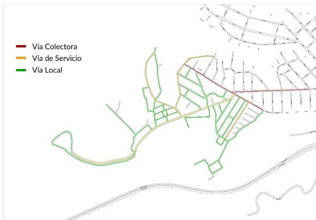
FIGURA 4 Propuesta de integración vial para Villa la Unión. Fuente: Melina García, arquitecta.
